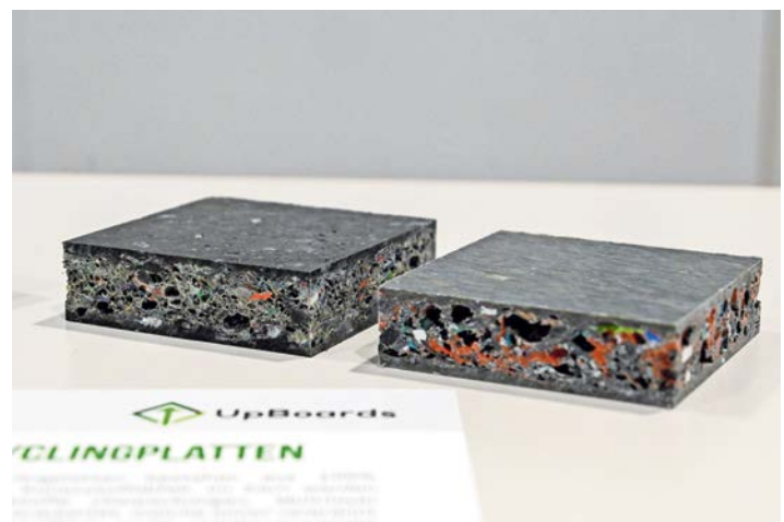
Beispiel für zirkuläre Wirtschaft: Die UpBoards GmbH produziert aus Mischkunststoffabfällen Recyclingplatten als Ersatz für Holzplatten.
